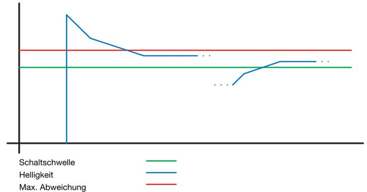
Abbildung 3: Bereich Konstantlichtregelung ausgeregelt
